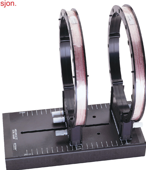
Helmholtzspoler, montert på baseplate
